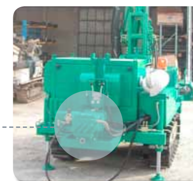
Exemples de pompes TRIPLEX montées sur foreuses Examples of TRIPLEX pumps mounted on drill rigs
